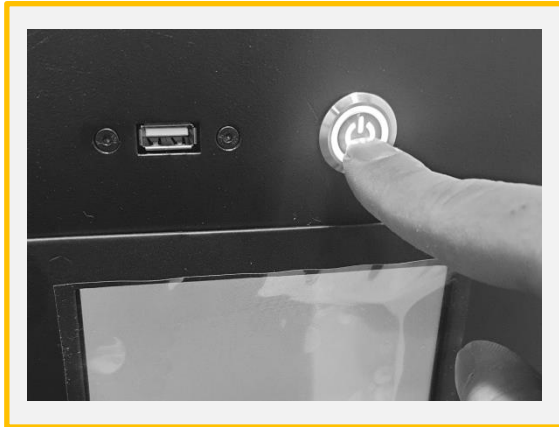
5. 正面にある電源スイッチを長押し（約5秒）し、プリンタを起動させます。
